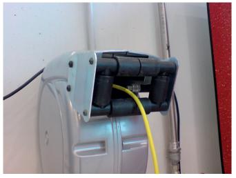
Zug-Kabelrolle Alu-Druckguss Typ PRC für den Potentialausgleich (in der Flugzeugtechnik ein Muss):
